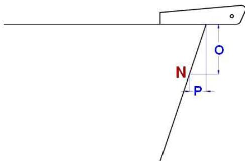
Per poter verificare la compatibilità, la reale sporgenza e la realizzazione di un musone ancora adatto, abbiamo bisogno di alcune misure della prua dell'imbarcazione.
